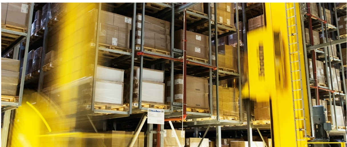
Abbildung 2: Logistikperformance mit bis zu 4 m/s Geschwindigkeit im automatischen Hochregallager
