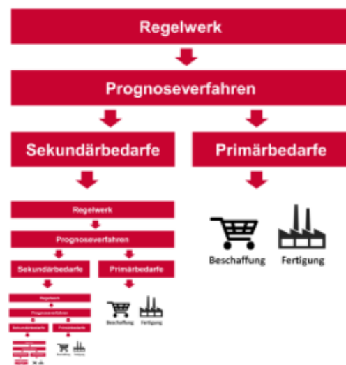
Abbildung 2: Auf Basis der Stückzahlenprognose des Endprodukts berechnet SEEPEX mit DISCOVER SCO auch alle Sekundärbedarfe, für die wiederum komplett eigenständige Regelwerke und Prognoseverfahren genutzt werden, die unabhängig vom Endprodukt sind. Dieses Szenario ist beliebig kaskadierbar.
