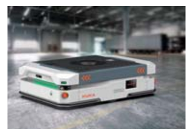
Die KMP 600P eignet sich für eine effiziente Materialversorgung vom Lager zu Stationen oder Fließband- und Vormontagelinien.
