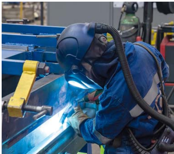
Manuelles Kehlnahtschweißen mit der TransSteel 5000 Pulse in PB-Position.
