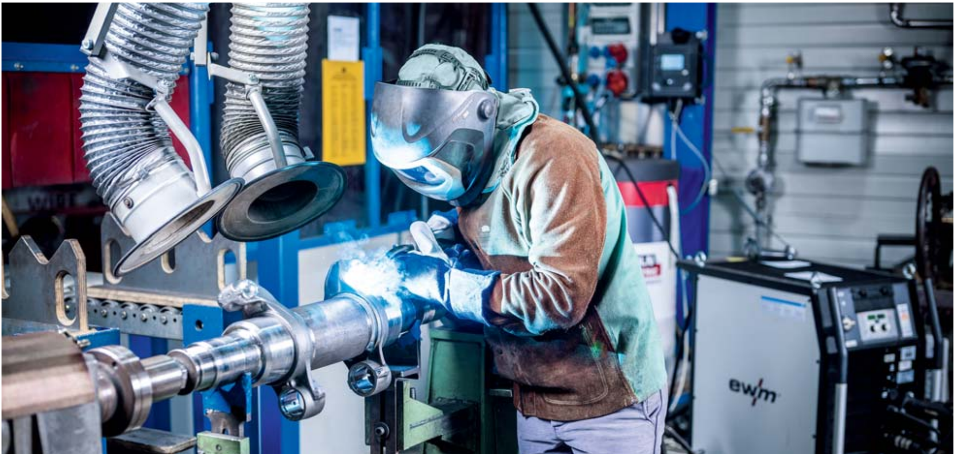
Ein Schweißer der SAF-Holland Group schweißt über eine Drehvorrichtung an einer Sonderachse. Das Unternehmen nutzt das Schweißmanagement-System ewm Xnet zur Sicherstellung gleichbleibender Schweißnahtqualität.
