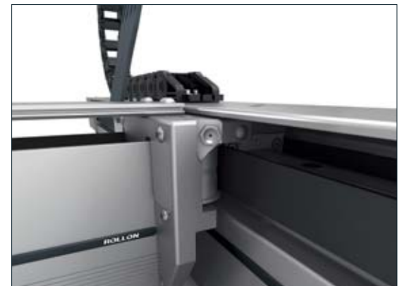
Die Kugelumlaufführungen können automatisch oder manuell über Schmiernippel geschmiert werden.
