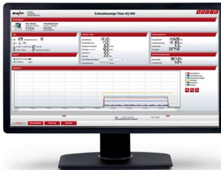
Alle Schweißparameter im Blick: Über die Echtzeitanzeige von ewm Xnet lassen sich vom Büro aus Status und Einstellungen der vernetzten Schweißgeräte laufend verfolgen.
