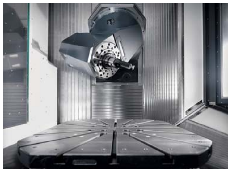
Bearbeitet auch komplexe Geometrien in fünf Achsen: Der Schwenkkopf mit Motorspindel.
