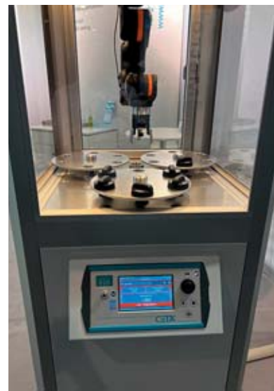
Links: Prüfstand zur Dichtheitsprüfung von Tankdeckeln | Rechts: Ceta-Prüfgeräteprogramm.
