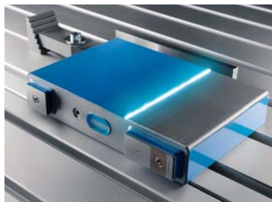
Darstellung einer prismatischen Batteriezelle (Material: Al): Die Batteriezelle wird vor der Aufbringung der dielektrischen UV-Beschichtung mit einem gepulsten Laser gereinigt, um die Haftfestigkeit zu erhöhen.
